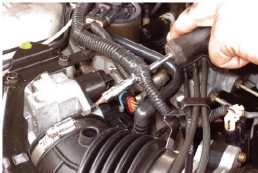
Desconecta eléctricamente la válvula.
